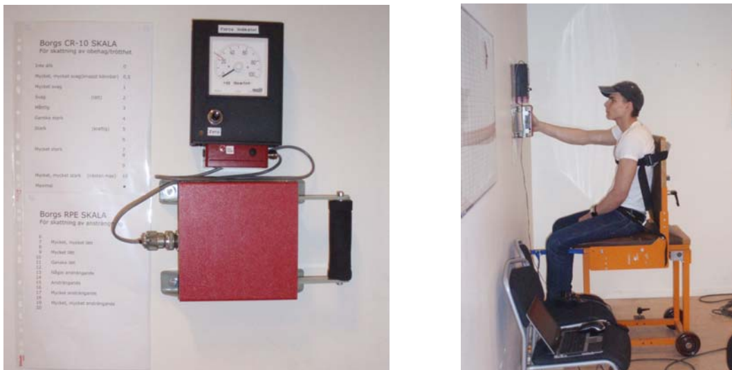
Figur 4. Illustration av hur försöken genomfördes. Utrustningen samt Borgskalorna (vänster) och kroppsställningen (höger). Under försöken tryckte den medverkande på det svarta handtaget med definierad kraft under en viss tid.
